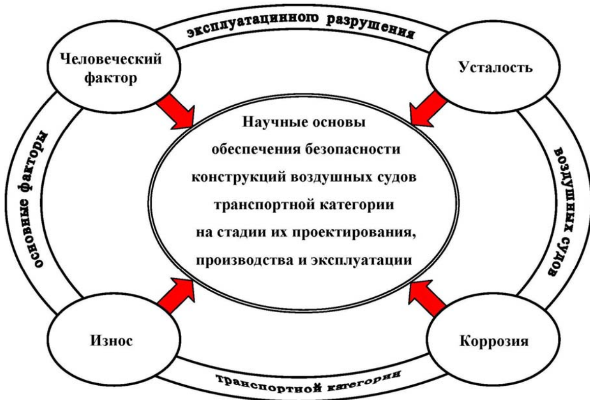
Рисунок 2 – Основные факторы эксплуатационного разрушения воздушных судов транспортной категории, формирующие проблему обеспечения безопасности их конструкций на стадиях жизненного цикла
