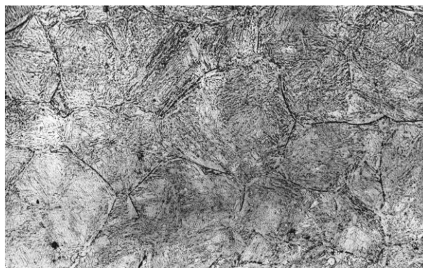
Рисунок 8 – Карбидная сетка в микроструктуре полусферы (травление электролитическое в 10%-ном растворе щавелевой кислоты), х 500
