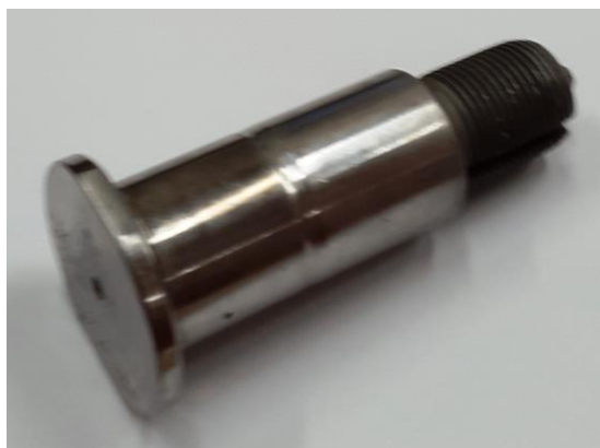
Рисунок 9 – Общий вид оси-болта из стали 95X18
