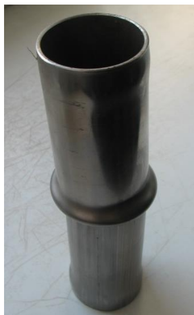
Рисунок 7 – Результат экспериментальной проверки редуцирования цилиндрического образца
