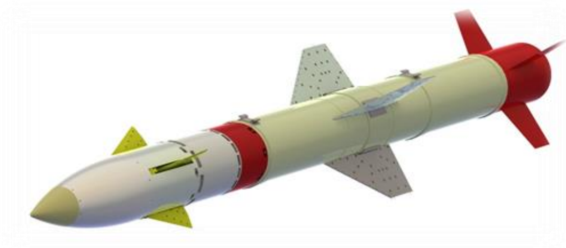
Рисунок 11 – Летательный аппарат с дестабилизатором (первые от носика – консоли дестабилизатора)
