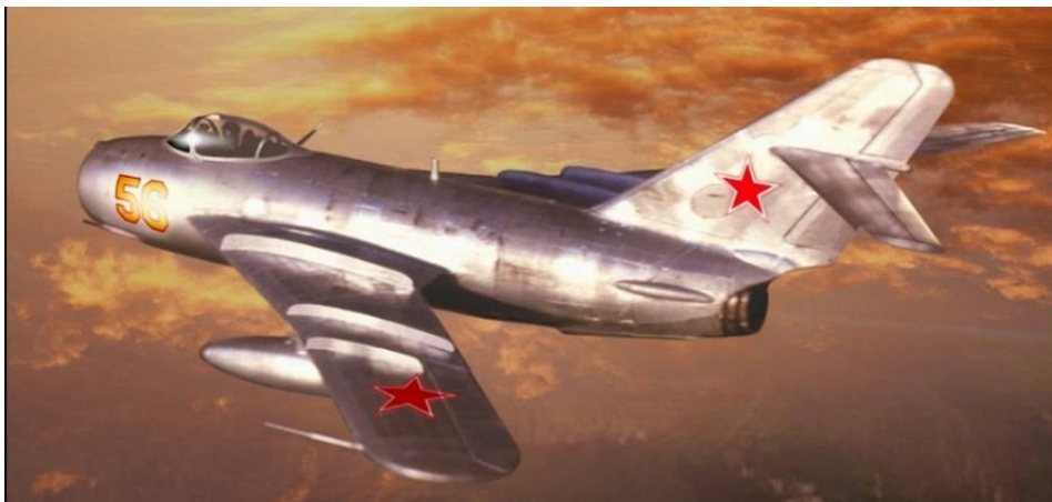
Рисунок 6 – Самолёт с аэродинамическими гребнями на крыле
