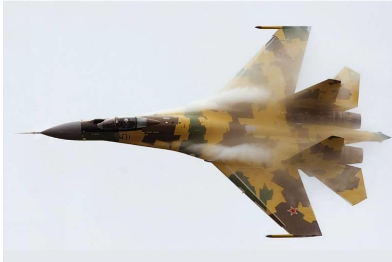
Рисунок 5 – Образование вихрей на передних кромках наплыва
