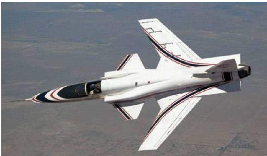
Рисунок 4 – Самолёт с крылом обратной стреловидности
