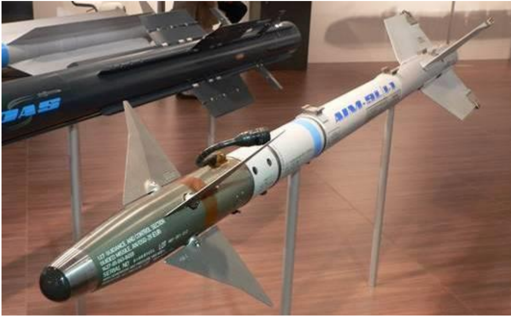
Рисунок 8 – Летательный аппарат с х-образным расположением консолей крыльев и рулей
