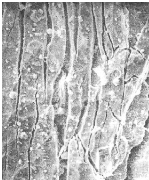
Рисунок 2 – Структура поверхности стали 11X11H2B2MФ в зоне разрушения.
