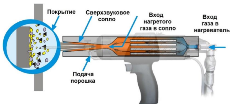
Рисунок 1 – Схема процесса газодинамического напыления на препрег
