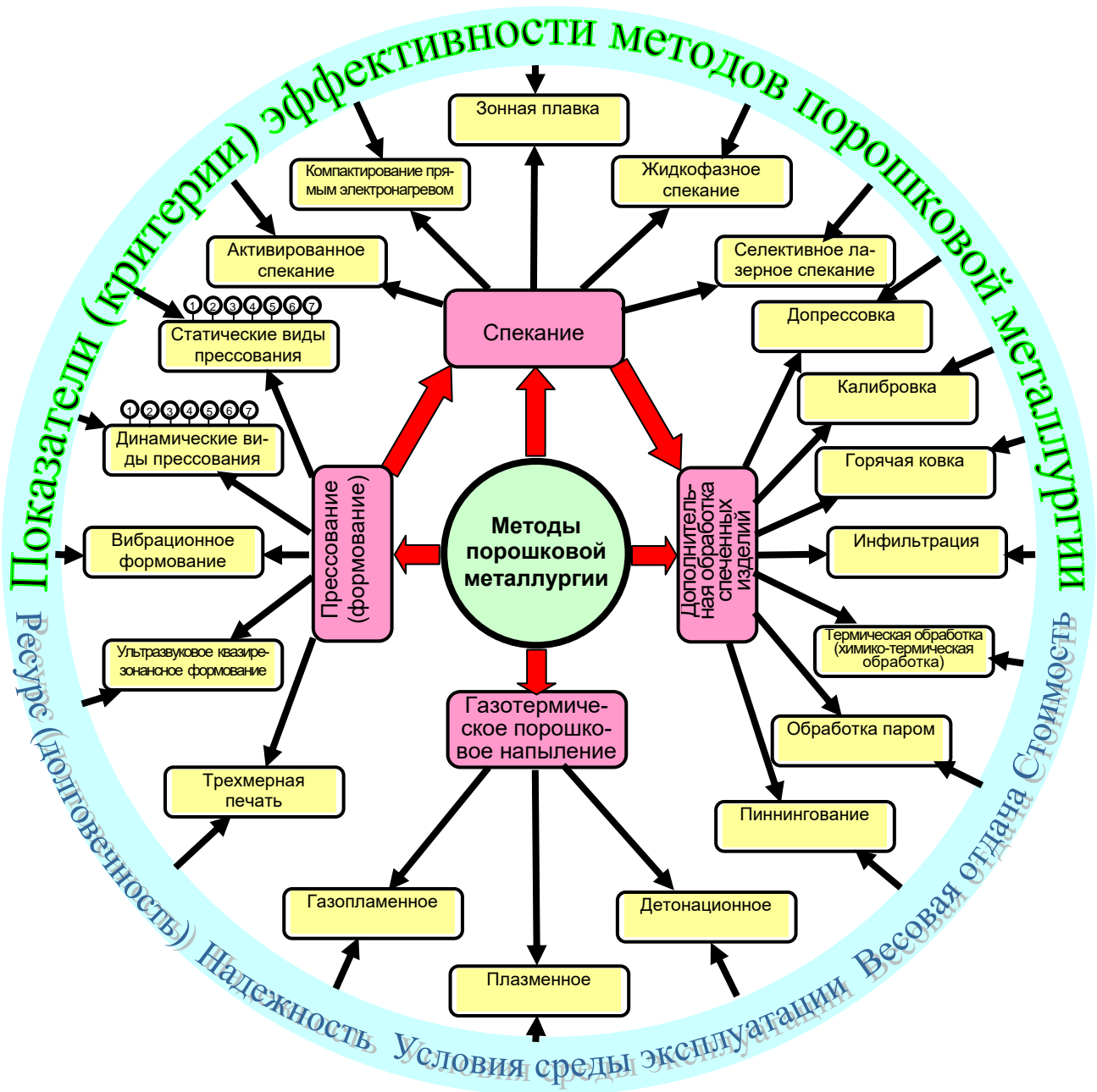
Рисунок 1 – Классификационная блок-схема основных методов порошковой металлургии, их составляющих и показателей эффективности при реализации для повышения эксплуатационных характеристик конструкции агрегатов самолетов
