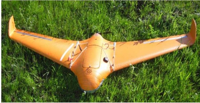
Рисунок 1 – Монокрыло Skywalker X8 с миниавтопилотом, разработанным в Национальном аэрокосмическом университете им. Н. Е. Жуковского «ХАИ», Харьков, Украина
