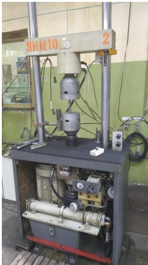
Рисунок 6 – Процес дослідження зразків на циклічну довговічність на установці «УИМ-10»
