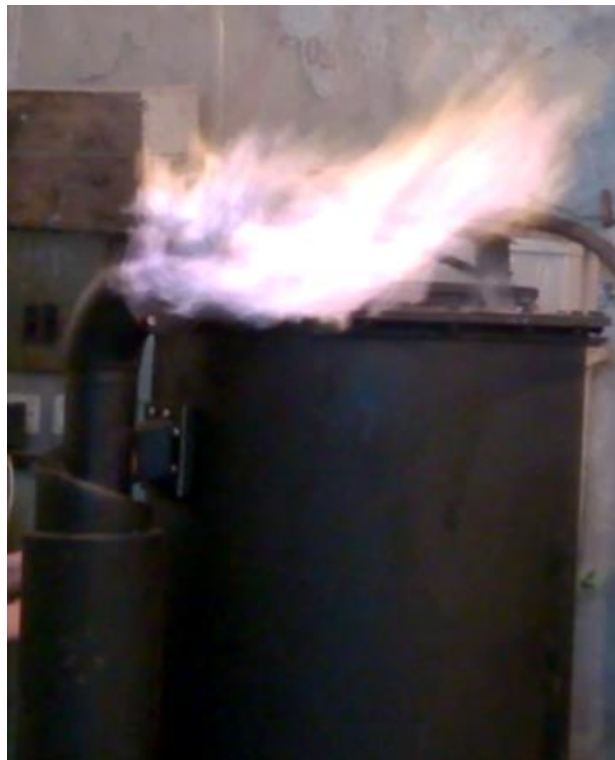
Рисунок 2 – Горіння генераторного газу на виході газифікатора
