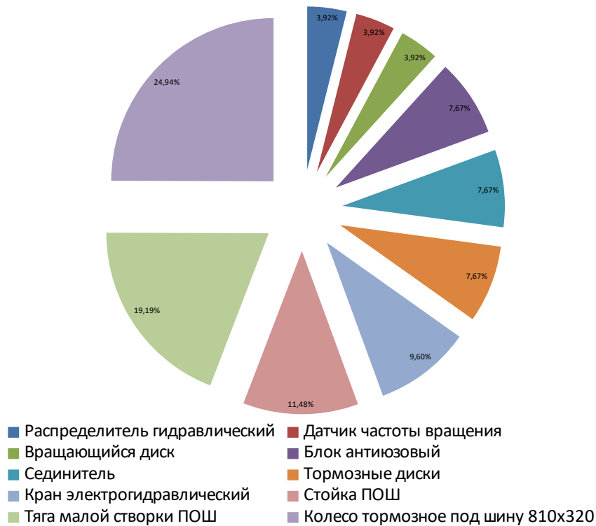
Рисунок 10 – Наиболее отказываемые элементы передней опоры шасси регионального пассажирского самолета Ан-140
