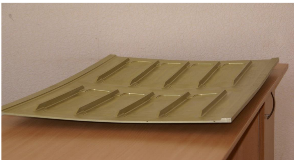
Рисунок 5 – Панель двойной кривизны со сложной внутренней гравюрой, отформованная методом местного изгиба с разводкой
