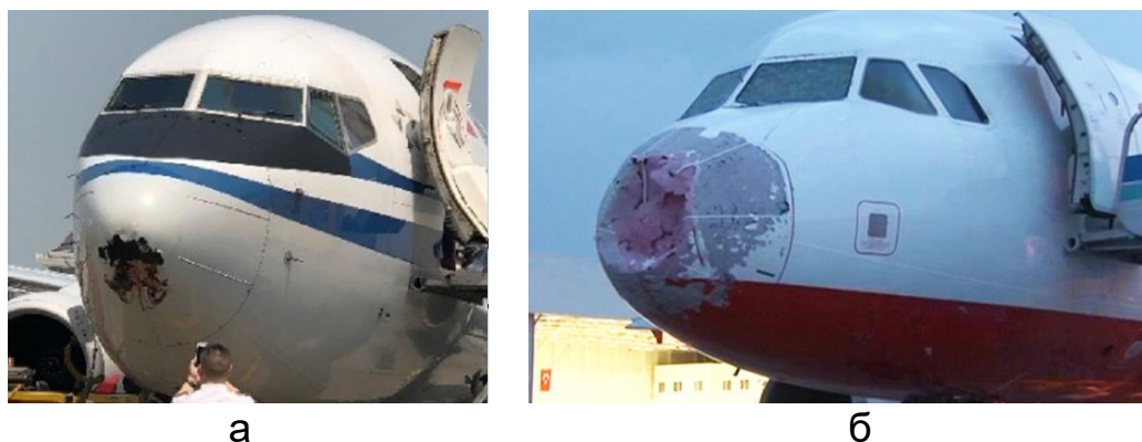
Рисунок 3 – Зовнішні пошкодження літаків: а – зіткнення літака з птахом; б – пошкодження літака градом
