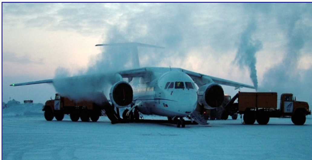
Рисунок 3 – Випробування при наднизьких температурах (до –55 °С). Якутськ, Нерюнгрі (Росія)
