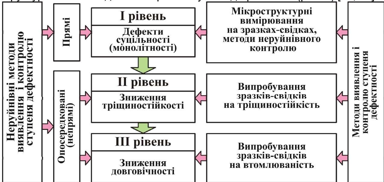
Рисунок 3 – Схема виявлення трьох рівнів дефектів структури ПКМ методами контролю ступеня дефектності
