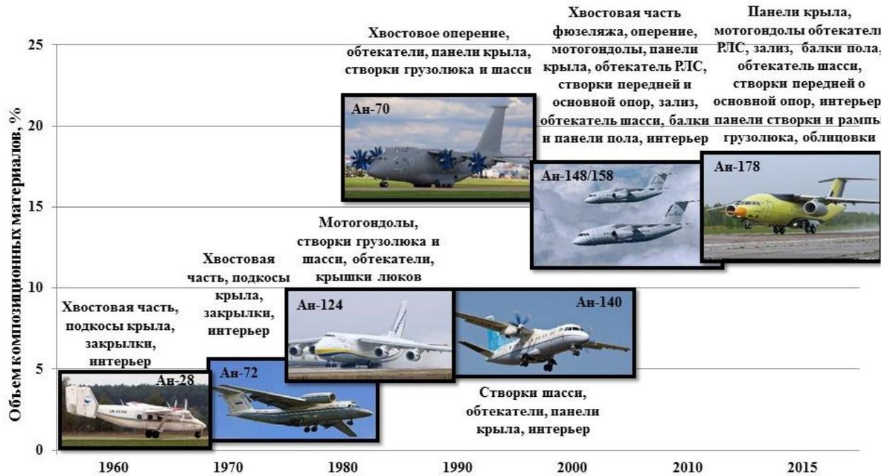
Рисунок 1 – Рост объемов применения ПКМ в отечественных самолетах
