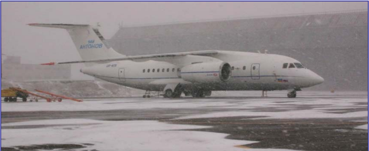
Рисунок 3 – Випробування літака в умовах природного зледеніння при температурах до -20\text{ }^{\circ}\text{C} (Архангельськ, Нарьян-Мар (Росія))
