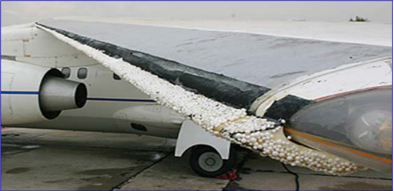
Рисунок 5 – Льотні випробування з імітаторами льоду
