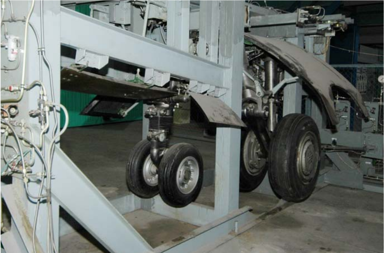
Рисунок 2 – Стенди дослідження роботи шасі літака
