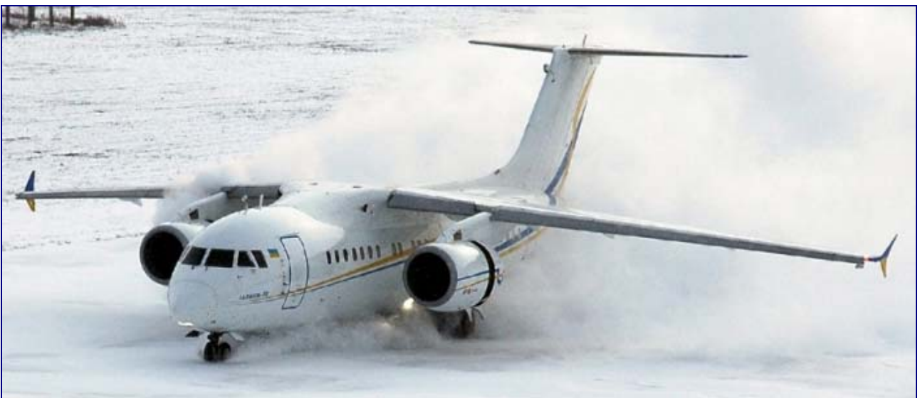
Рисунок 6 – Льотні випробування на ЗПС, покритих опадами
