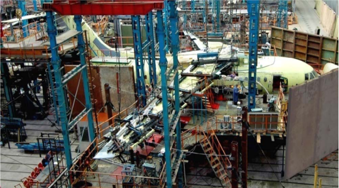
Рисунок 1 – Міцнісні дослідження планеру
