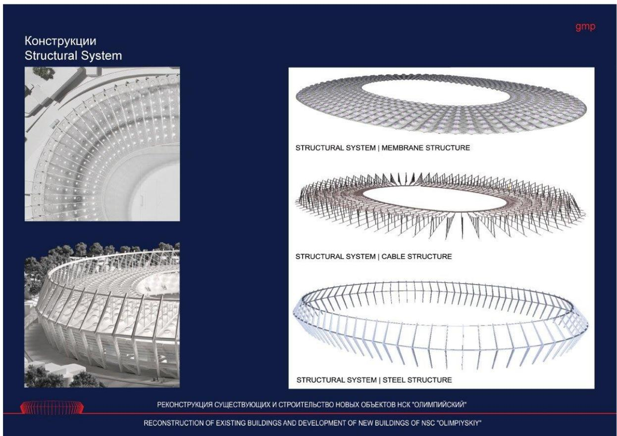
Рис.3. Конструкція даху НСК
