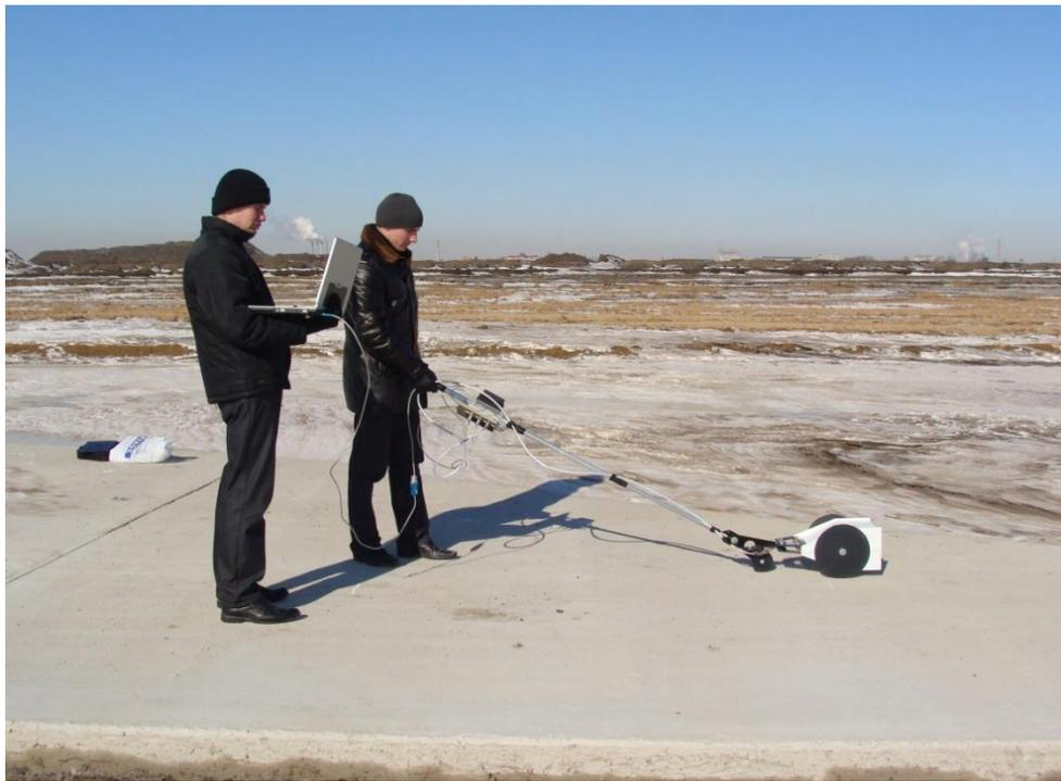
Рис. 1. Определение толщины цементобетонного основания с помощью георадара «Одяг»
