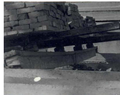
Рис.9.Залізобетоннітаврові прогони в процесівипробувань
