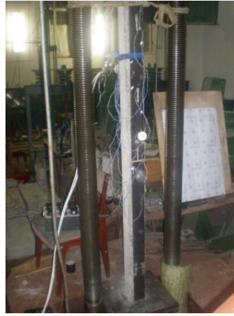
Рис. 3. Випробування сталезалізобетонної стійки висотою 2 м
