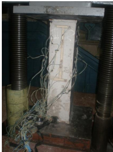
Рис. 4. Випробування сталезалізобетонної призми
