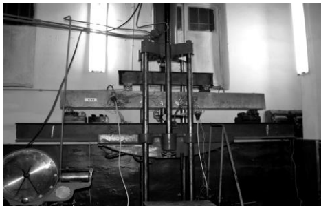
Рис. 2. Схема установки для випробування зразків на дію згинального моменту
