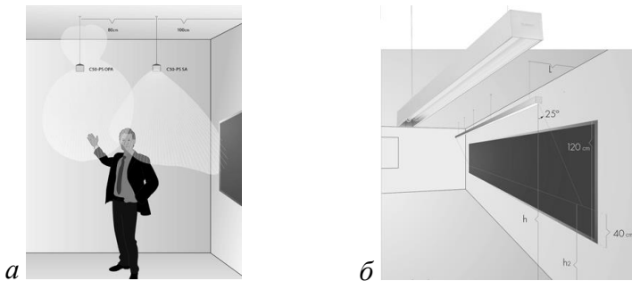
рис. 1. Презентаційне освітлення: а - місця доповідача; б - освітлення дошки.
