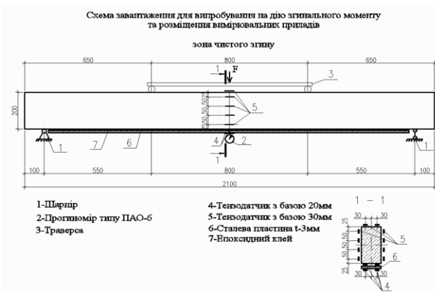
рис. 1. Схема завантаження для випробування на дію згинального моменту
