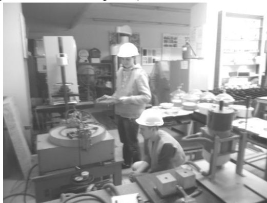
рис. 2. Визначення стираності на приладі ЛКИ-3
