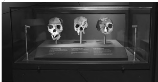
Рис. 5. Освітлення, вмонтоване в музейне обладнання: а) вітрина з вмонтованими регульованими світильниками
