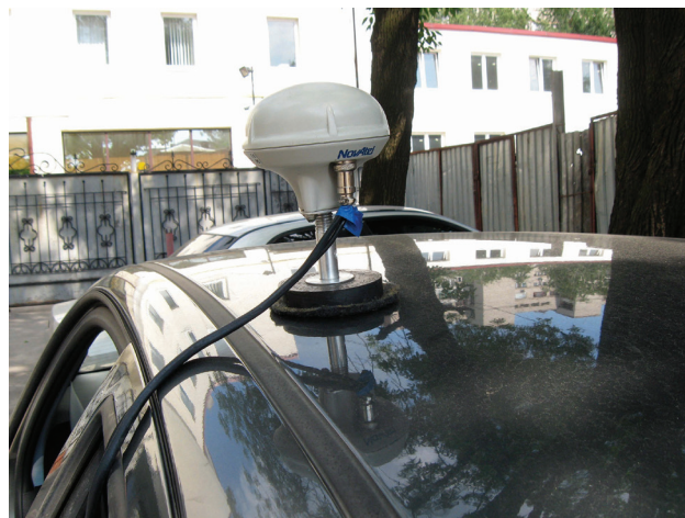
Рис. 2. Крепление SMART-антенны на крыше автомобиля
