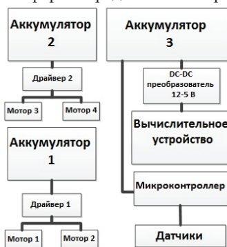
Рис. 2. Система энергоснабжения платформы
