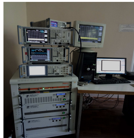
Рис. 5. Автоматизированная система под управлением ПО R&S®EMC32
