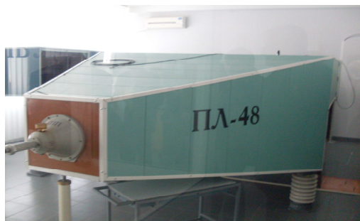
Рис. 3. Рабочий эталон единицы импульсного электрического и магнитного полей (ТЕМ-камера)
