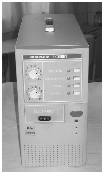
Рис. 2. Апарат високочастотного електрохірургічного зварювання «Патонмед ЕК-300М1»
