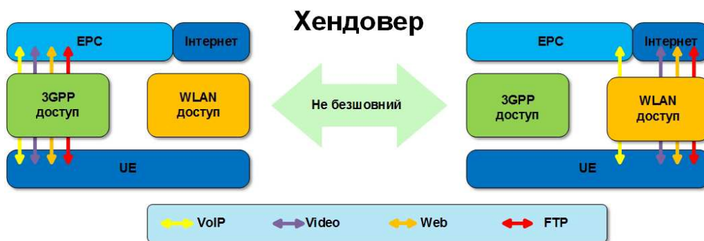
Рис. 7. Процедура повного WLAN-розвантаження на базі IP-мобільності
