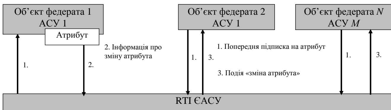
Рис. 1. Схема обміну значеннями атрибутів через RTI
