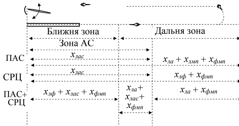
Рис. 4. Ілюстрації сигналів відображення в режимах роботи первинного каналу ПРЛ
