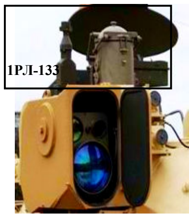
Рис. 2. Станція 1РЛ133 “Кредо” для ведення радіолокаційної розвідки в складі броньованих машин
