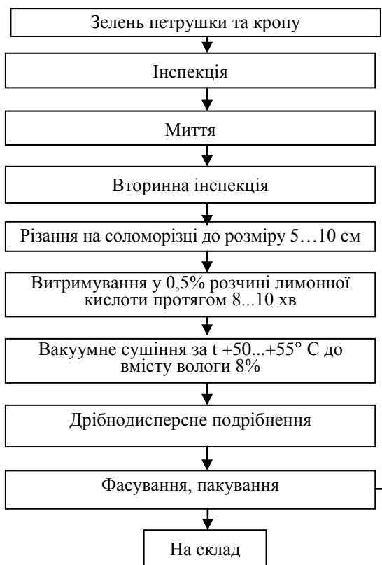
Рисунок 1 – Технологічна схема виробництва порошкоподібних наноструктурованих порошоків-барвників із зелені петрушки та кропу із застосуванням дрібнодисперсного подрібнення (ТУ У 15.3-01566330-182-2005)
