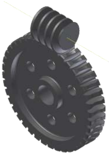
Рис.8. Результат виконання лабораторної роботи з застосуванням програмного забезпечення Inventor (черв'ячна передача)
