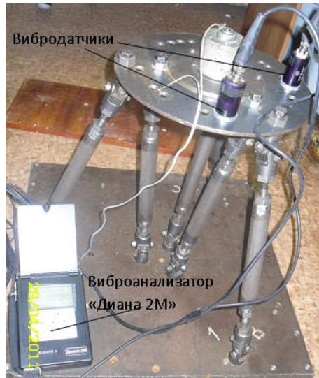
Рис. 8. Експериментальна установка в положенні, відповідному найбільшій жорсткості.
