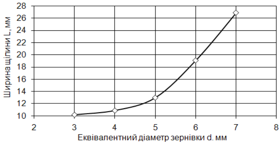
Рис. 3. Графік залежності ширини щілини L від еквівалентного діаметру зернівки d .
