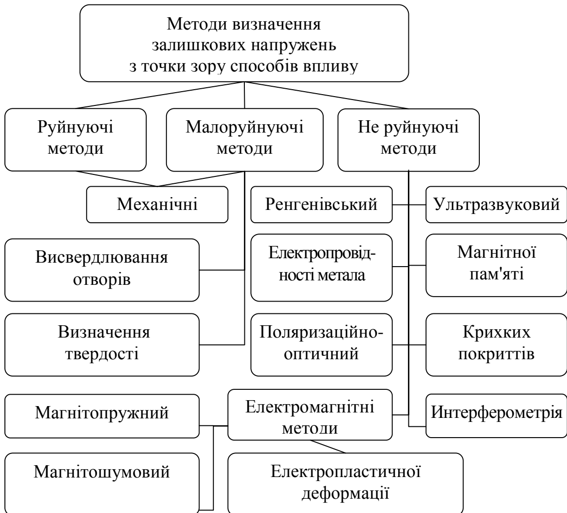
Рис. 1. Методи вимірювань залишкових напружень з точки зору способів впливу.
