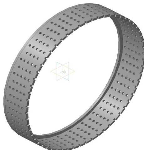
Рис. 2 – Робочі колеса дезінтегратора: 1 – робочі диски; 2 – робочі кільця. Рис.3 – Робоче кільце.
