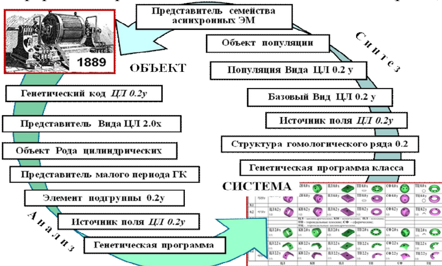
Рис. 3. Иллюстрация принципа системности на примере генетически взаимосвязанных ЭМ-объекта (первый трехфазный асинхронный двигатель М.О. Доливо-Добровольского) и генетической программы класса трехфазных асинхронных машин (Порождающая система).
