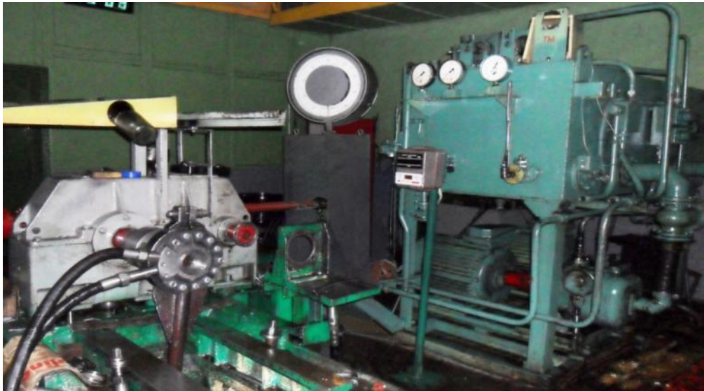
Рис. 1. Стенд для испытания гидравлических вращателей планетарного типа
