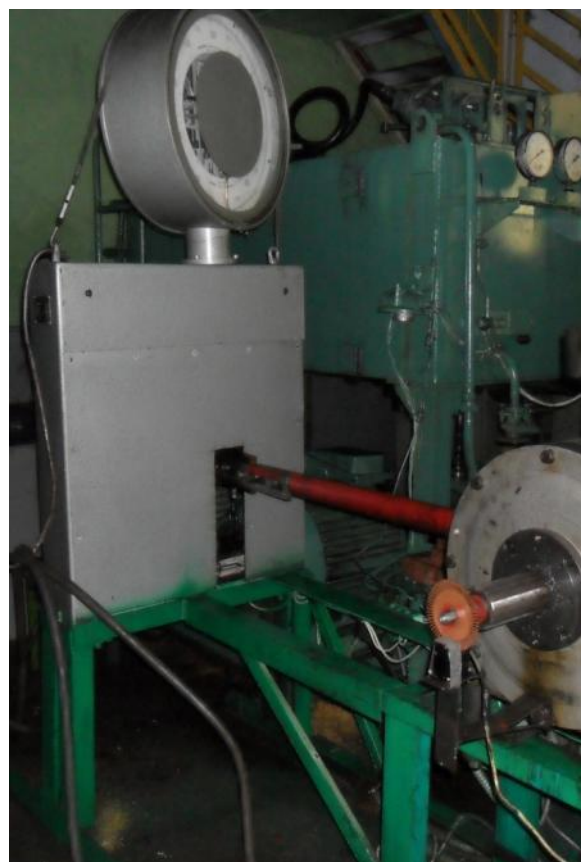
Рис. 6. Балансирное устройство для измерения крутящего момента планетарных гидровращателей
