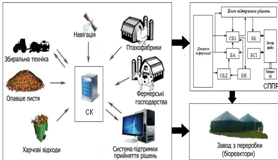
Рис. 6. Інтелектуальна система підтримки прийняття рішень при керуванні процесами пошуку збору та переробки органічної сировини: СК – система керування; СППР – система підтримки прийняття рішень; СБД – ситуативна база даних, СБЗ – спеціалізована база знань, БА – блок аналізу, БН – блок навчання, БК – блок коментарів, БСІ – блок синтезу інформаційної моделі.
