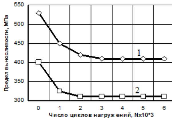
Рис. 3. Вплив шліфувального прижогу на межу витривалості сталі 40Х: 1 – без прижога; 2 – з прижогом
