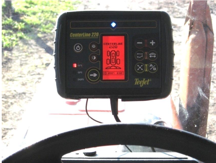
Рис. 3. Кабіна трактора, обладнана GPS-навігатором
