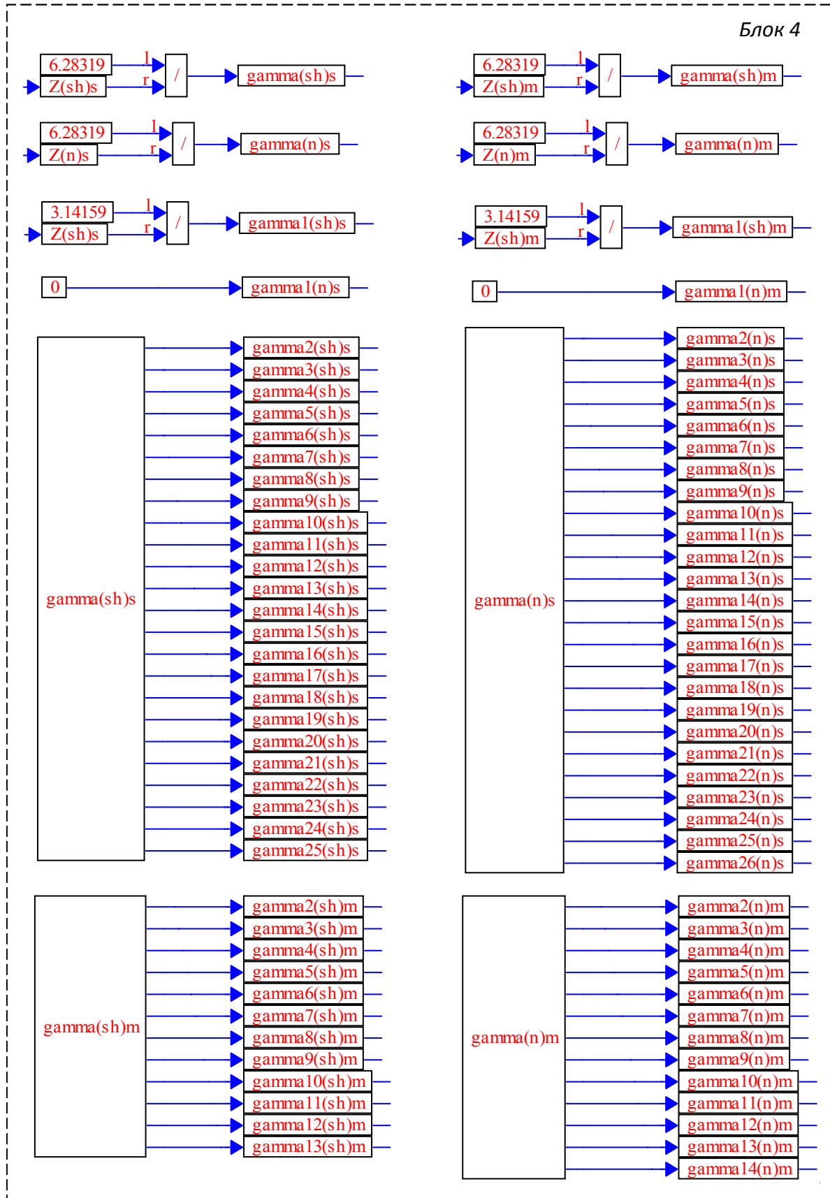
Рис. 4. Блок визначення кутів розташування центрів зубів шестерні і напрямної серійного і модернізованого гідрообертачів
