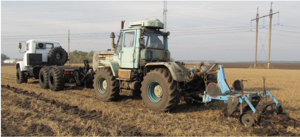
Рис. 2. Тягові випробування МЕЗ-330 «Автотрактор».
