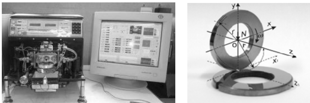
Рис. 11 – Внешний вид машины трения АСК-01 (а) и модельной трибосистемы скольжения с линейным контактом (б)
