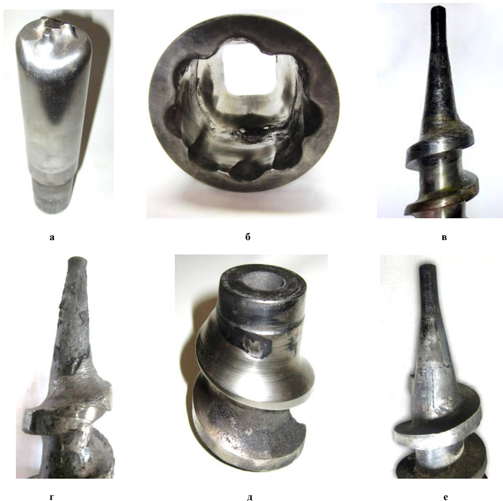
Рис. 3 – Зовнішній вигляд зношених робочих органів обладнання для виготовлення паливних брикетів: а – брикетувальний пуансон; б – формуюча втулка; в – суцільний однозахідний шнек (рівномірне зношування); г – суцільний однозахідний шнек (інтенсивне відшарування); д – вставка збірного шнека; е – суцільний однозахідний шнек з впаяними твердосплавними пластинами
