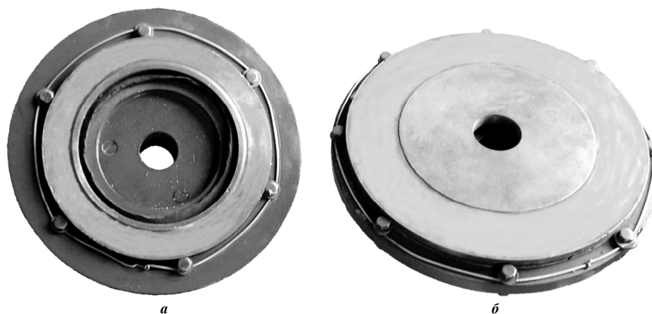
Рис. 1 – Общий вид рабочих поверхностей приспособления для наплавки наружной кромки штампов
